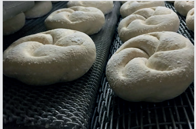
N300 Weitspiral-Runddraht-Gliedergurt mit S-Kanten und verschweißten Kanten
