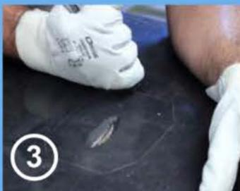
Ziehen Sie mit dem Messer an der Linie entlang. Nicht die Karkasse des Förderbandes beschädigen.
