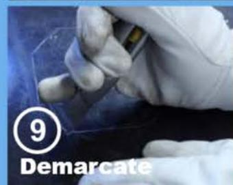
Ziehen Sie mit dem Messer der Linie entlang. Nicht in die Karkasse schneiden
