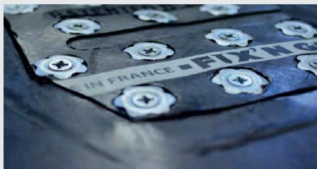
Mit FIX'N GO® erstellen Sie eine dauerhafte Reparatur. Die Spezialschrauben sind selbstschneidend, wobei die Gewebefasern verdrängt und nicht geschnitten werden. Es ist für Längsrisse, Randrisse, Löcher und für die Verbindung von 2 Fördergurten in Längsrichtung geeignet. Gewebegurte bis zu einer Reißfestigkeit von 1.250 N/mm können mit FIX'N GO repariert werden.
