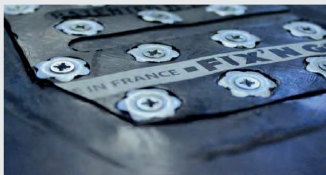
Mit FIX'N GO® erstellen Sie eine dauerhafte Reparatur. Die Spezialschrauben sind selbstschneidend, wobei die Gewebefasern verdrängt und nicht geschnitten werden. Es ist für Längsrisse, Randrisse, Löcher und für die Verbindung von 2 Fördergurten in Längsrichtung geeignet. Gewebegurte bis zu einer Reißfestigkeit von 1.250 N/mm können mit FIX'N GO repariert werden.
