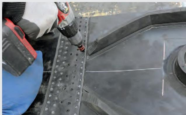
Super-Screw kann dank des Schraubensystems überall installiert werden, auch bei schlechten Wetterverhältnissen und engen Platzverhältnissen. Die Verbindung ist flexibel, dicht und kompatibel mit Abstreifern.
